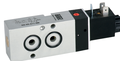
Distributeurs 3/2, 5/2 et 5/3 selon NAMUR - G1/4 - 900 Nl/min Série KN-05, KN-55
