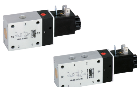
Distributeurs 5/2 et 5/3 - G1/8 950 NI/min - Série KM-09
